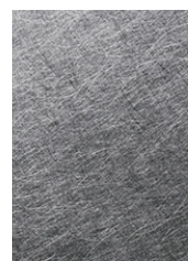
パイブレーション仕上げ
